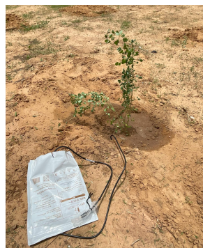
水ポテンシャルセンサーを設置し、スマートフォンでの測定値読み取りを確認
