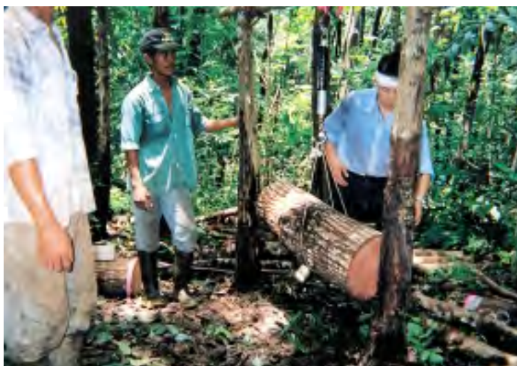
玉切りした丸太の重量測定（マホガニー）
