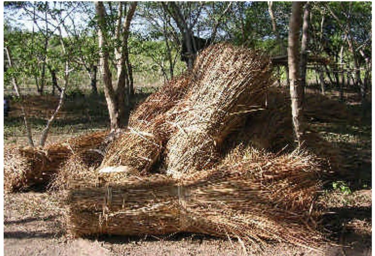
写真15 屋根の材料として利用される
