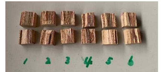
写真4 曲げ試験の破壊状況
