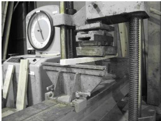
写真1 曲げ試験状況
