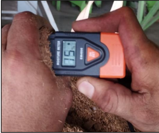
木くずの含水率計測
