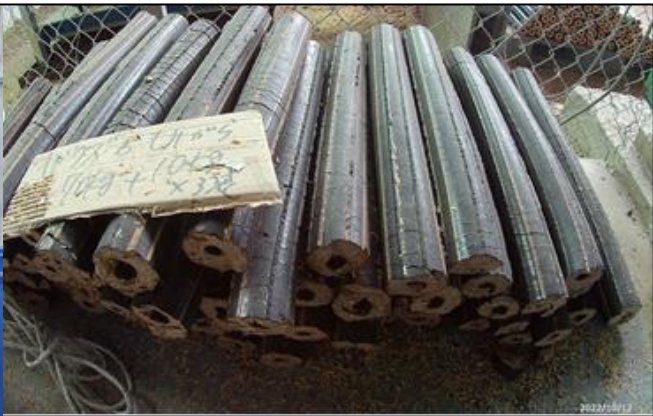
木くず50%：もみ殻50%混合ブリケット量産(サンプル提供用)
