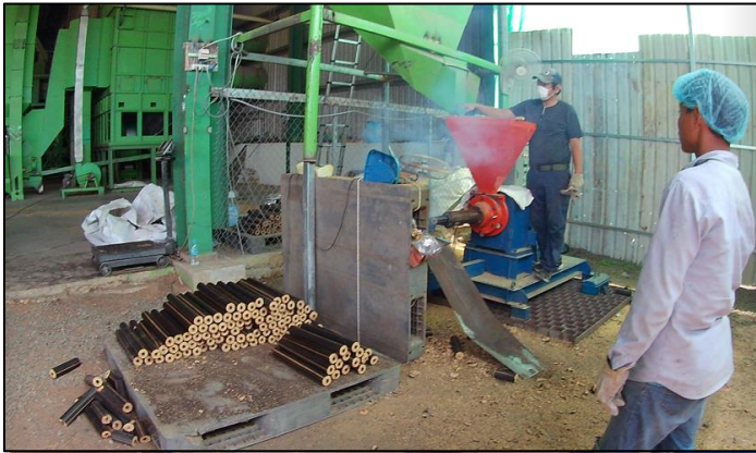
木くず50%：もみ殻50%混合ブリケット量産(サンプル提供用)
