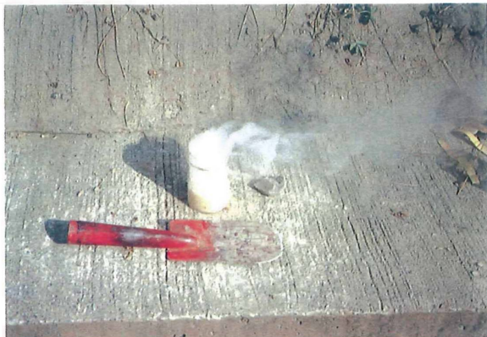
写真16 過酸化水素と反応し白煙を上げる黄鉄鉱を含む土壤
