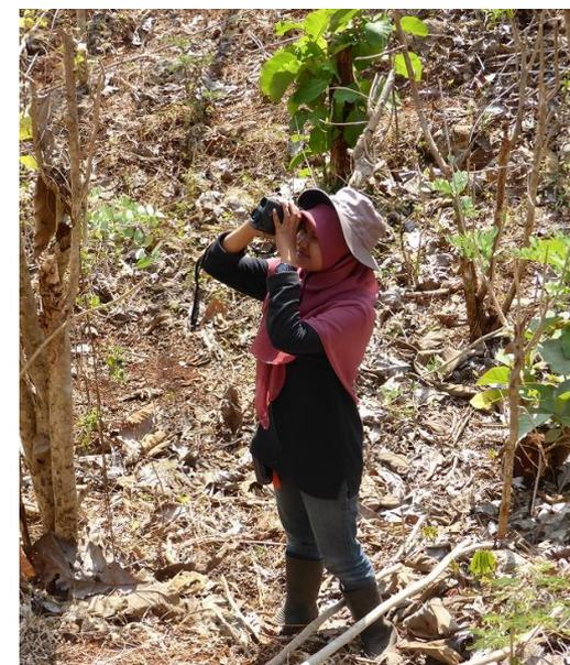
レーザー距離計を用いた樹高の測定 5
