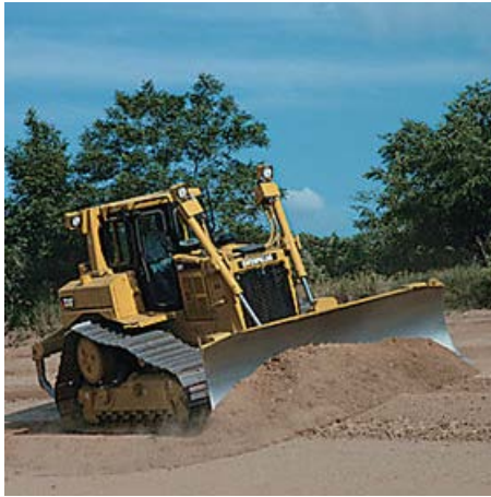
写真1 ブレードを使用してのリッピング
