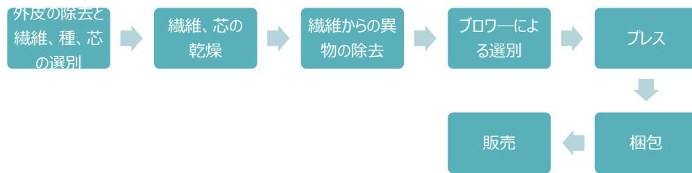
図 1-1-6..カポック果実から繊維への加工プロセス
