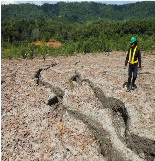
写真 3-2-4 AGM 試験地原材料区で観察されたガリーエロージョン。
