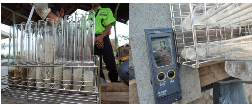
写真 3-2-13 現地事務所での過酸化酸素による酸化と \text{pH}_{\text{Hox}} の測定。試料によって、激しい発泡、発熱がみられる。
