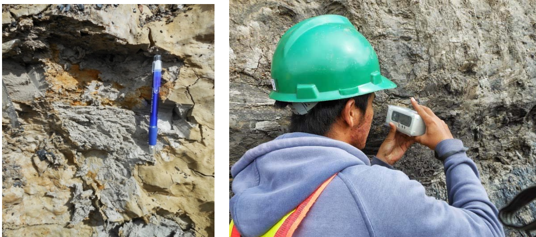
写真 3-2-12 時間を経た堆積層の表面は酸化鉄の被膜によって覆われているため（左）、ナイフで表面の酸化した部分をはぎ取って新鮮な材料を露出させた後に、土色計を用いて色の測定を行った(右)。1つの層に対して 10 回測定を繰り返し、平均値を算出した。
