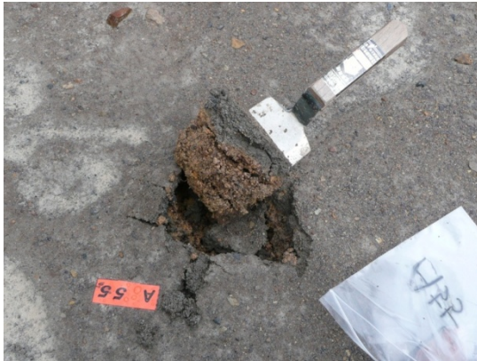
写真 3-5-3. 植え穴客土区に堆積した 土壌流亡により流されてきた強酸性土壌
