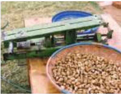
写真 45: 内果皮は硬く、専用の Cutter で切断する
