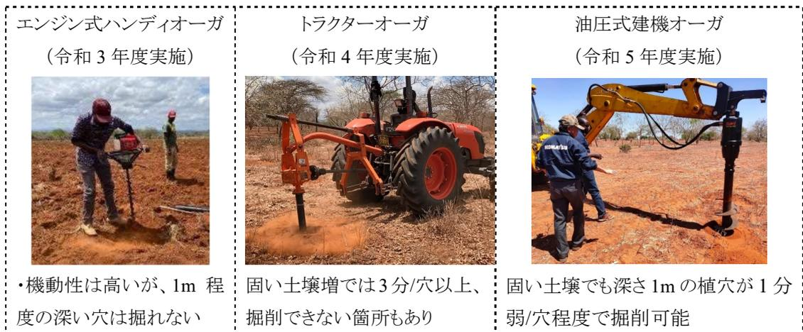
図 3-15 植穴掘削方法の比較
