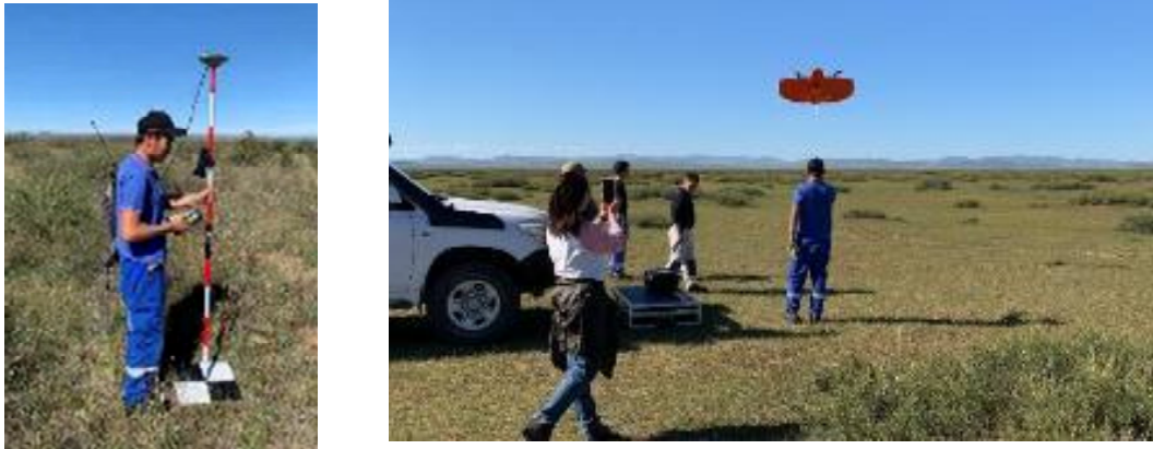
図 5-8 作業風景(左:GCP 測量、右:UAV 飛行)
