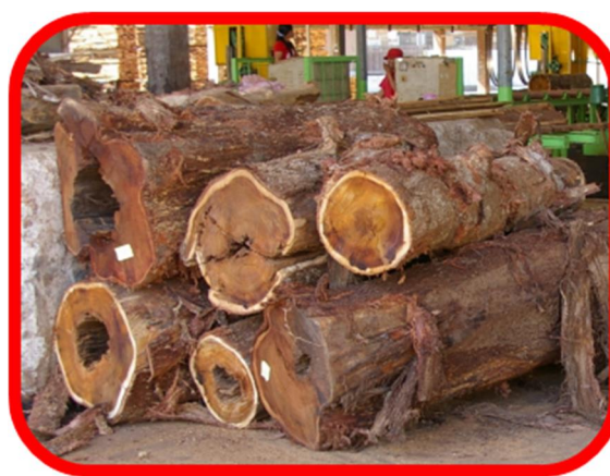
写真 4-2 アカシア・マンギウムの芯腐れ
