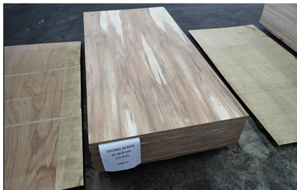
写真 4-15 スック植林地から収穫されたアカシア・ハイブリッドを用いて試験的に製造された合板
