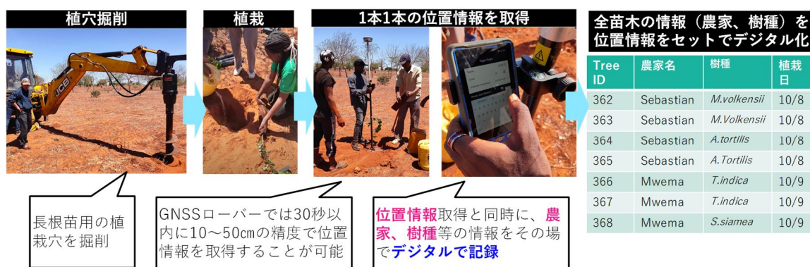
図 3-23 GNSS ローバーを用いた植林木の位置情報取得方法
