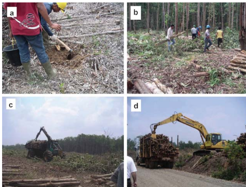
写真 2 M 植林地 (a: 植付 b: 伐木・造材 c: フォワーダ集材 d: 林道端での積み込み)
