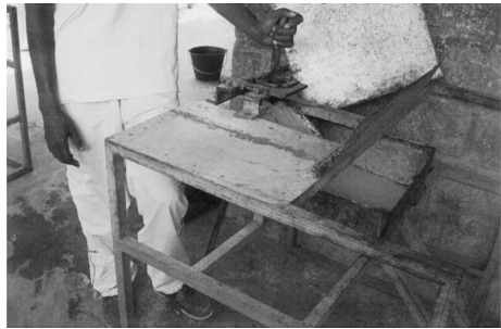
写真 5 Enterprise Works が導入しているブラジル式の殻取り用機械
