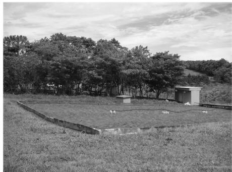
写真 7 USLE（汎用侵食量計算式）で使われる斜面長 22.1 m の侵食プロット試験地（手前が農耕裸地プロット、奥が広葉樹植栽プロット）
