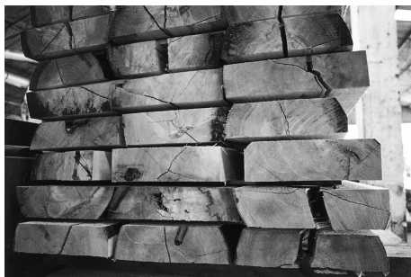
写真 4 成長応力によるグランディスユーカリ製材における割れ目
