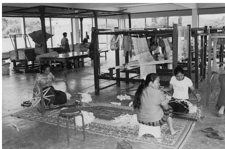
写真 3 センター内展示棟での紙布織り風景 左奥の紙漉場で手漉紙を作り、手前の糸繰りをつかって紙を糸状に絞る。それを横糸、木綿を縦糸にを使って手織で紙布織りを作る
