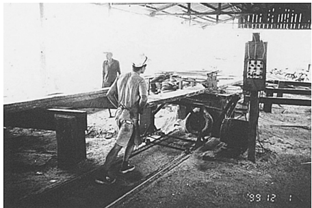
写真 4 製材工場。材木を押して電動鋸で製材する。
