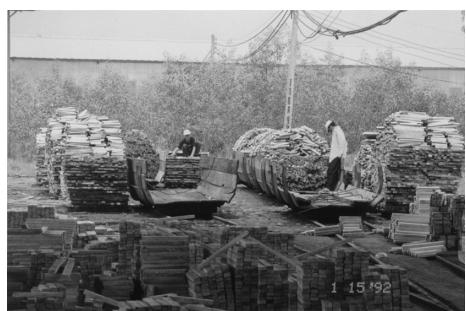
写真 5 加圧注入プラントで防虫処理されたパラゴムノキ
