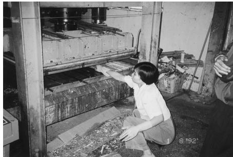
写真 4 バンブーフローリングの圧縮のための 4 面プレス機
