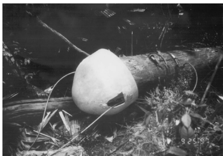
写真 3 木寄せコーンを利用した長距離集材の試験 (FRIM)
