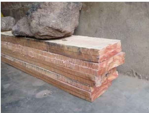
写真 17 製材した板が反らないように、重石をのせてゆっくり乾燥させる
