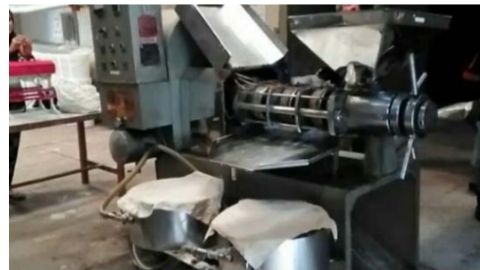
搾油機のカバーを外した様子 (搾油機内部は 50℃程度に保たれる)
