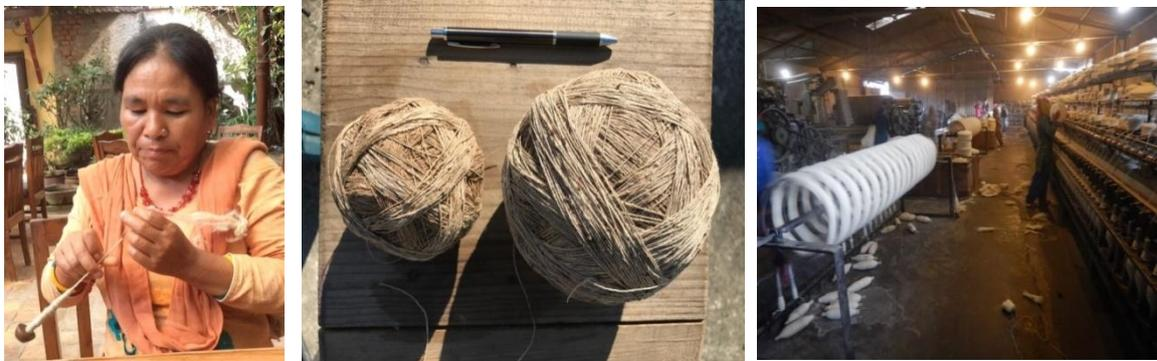
図 10 スピンドルによる紡ぎ作業（左）、HN 糸毬（中）、紡績工場にある大型紡績機（右）
