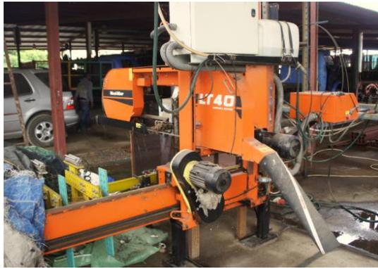
図 3-23. S 社はレーザー照準、機械による固定・薄い刃等を工夫
